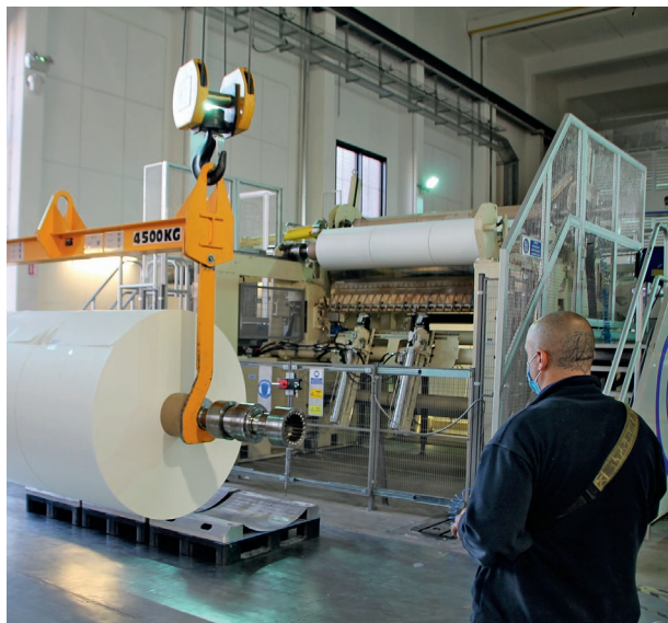
↑ À la papeterie EUROPAFI, la machine à papier M3F fabrique le papier fiduciaire
